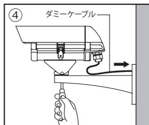
カメラの向きや角度を調整し接合部のネジをしっかりと締め固定します。ダミーケーブルをブラケットの穴に差し込みます。外れやすい場合は接着剤等で固定してください。
