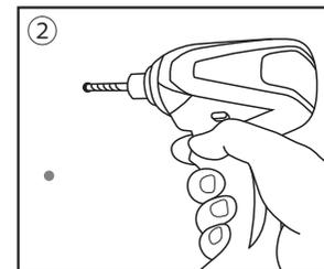
印をつけたネジ穴の位置にドリルなどで約Φ2mm程度の穴を開けます。
