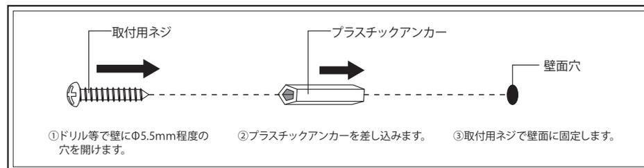
ブロック・煉瓦・コンクリート壁などに設置する場合は、コンクリートドリル等で壁に穴を開けます。その後、付属のプラスチックアンカーを差し込みブラケットを取付用ネジでしっかりと固定してください。
