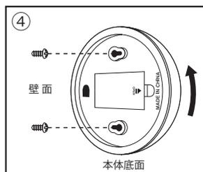
壁面のネジが本製品の取付ネジ穴に差し込まれるのを確認できたら、本製品を軽く右に回し溝にネジが引っ掛かるようにして取付けます。※外れやすい場合は両面テープ等で固定してください。
