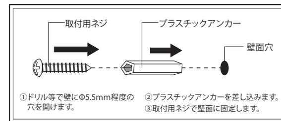
ブロック・煉瓦・コンクリート壁などに設置する場合は、コンクリートドリル等で壁に穴を開けます。その後、付属のプラスチックアンカーを差し込み、取付用ネジでしっかりと固定してください。
