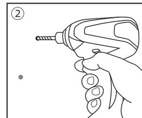
印をつけたネジ穴の位置にドリルなどで約Φ2mm程度の下穴を開けます。
