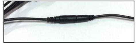
2. 絶縁ビニルテープをコネクタの端の電線部から巻いてゆき、接続した反対側のコネクタ電線部まで巻き進めます。
