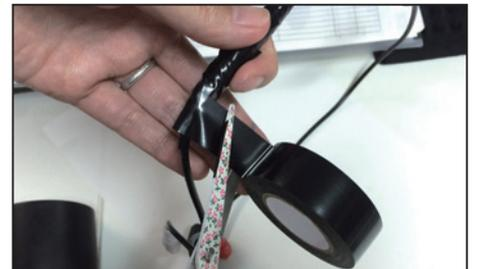
4. 隙間が出来ないようにしっかりと押さえて完了です。複数の端子にテープを巻く場合は、最初からまとめて巻かずに、まずは1端子ずつ巻いてください。全ての端子にテープを巻いたら、必要に応じてまとめて巻き付けます。
