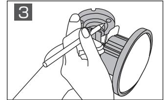
印をつけたネジ穴の位置にドリルなどで約φ2mm程度の下穴を開けます。
