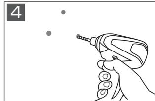
取付金具を付属の取付用ネジで、しっかりと固定します。
