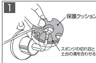
はじめにアーム土台の裏側に保護クッションを図のように溝が合うようにして貼り付けます。
