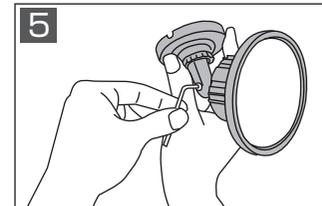
カメラ向きや固定アームの角度などを六角レンチで調整して設置完了です。
