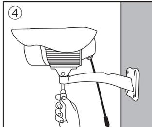
カメラの向きや角度を調整し接合部のネジをしっかりと締め固定します。
