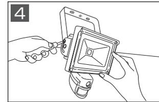
4 ②LEDライトの角度や人感センサーの向きを調整し、⑦角度調節ネジを締め、しっかりと固定します。
