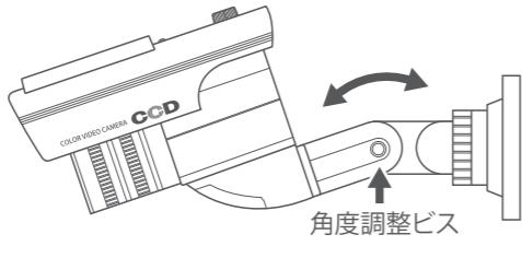
角度調整ビスをゆるめて、ブラケットの節を回転できます。
