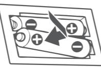
電池ボックス内部の表示に従い、電池の+/-を確認してセットしてください。電池をセットすると、赤色LEDが点滅を開始します。
