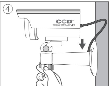
カメラの向きや角度を調整し接合部のネジをしっかりと締め固定します。
