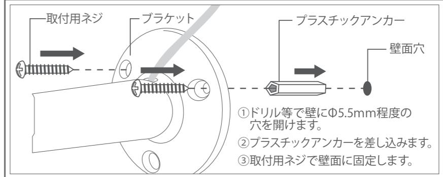
ブロック・煉瓦・コンクリート壁などに設置する場合は、コンクリートドリル等で壁に穴を開けます。その後、付属のプラスチックアンカーを差し込みブラケットを取付用ネジでしっかりと固定してください。
